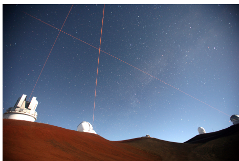
図 A.10: ハワイ、マウナケア山頂でレーザーガイド星を使用する様子。すばる望遠鏡 (左端)、Keck 望遠鏡 (左から 2 番目)、Gemini North 望遠鏡 (右端) からレーザーが出ているのが見える。ここでレーザー光が見えるのはレイリー散乱の影響である。 ([25])
