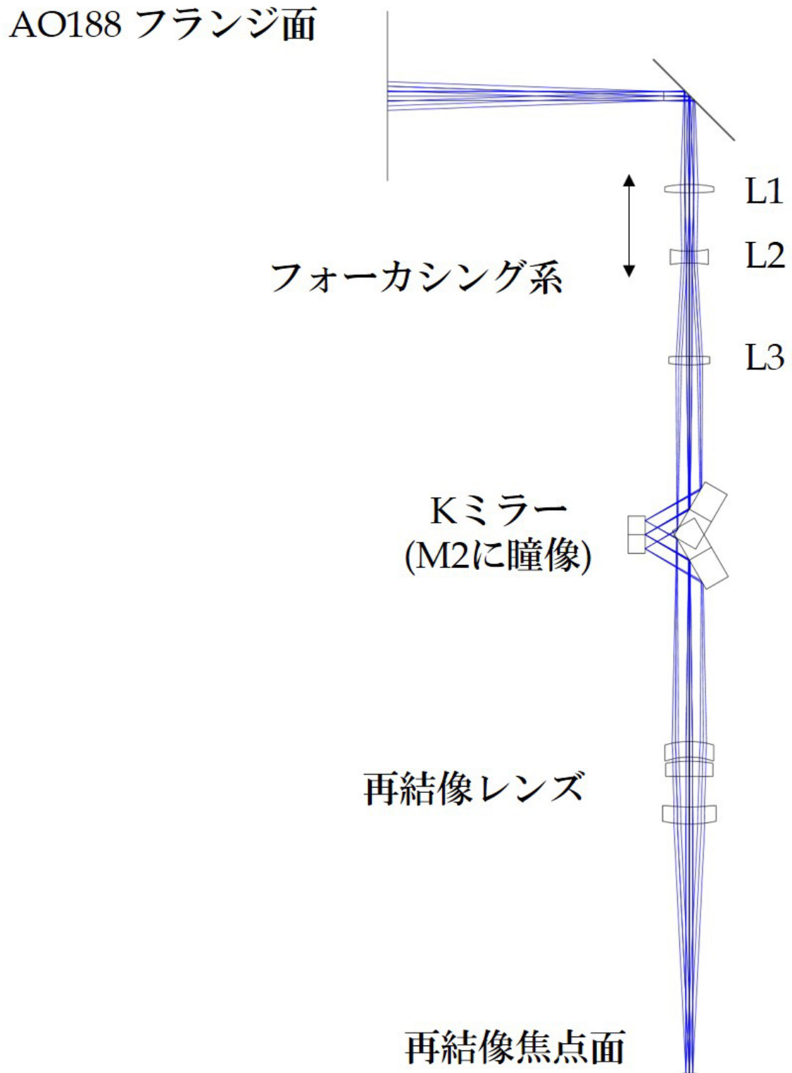
図 4.1 設計した前置光学系のレイアウトで、レーザーガイド星が 90km で配置間隔が 10 秒角の場合。
