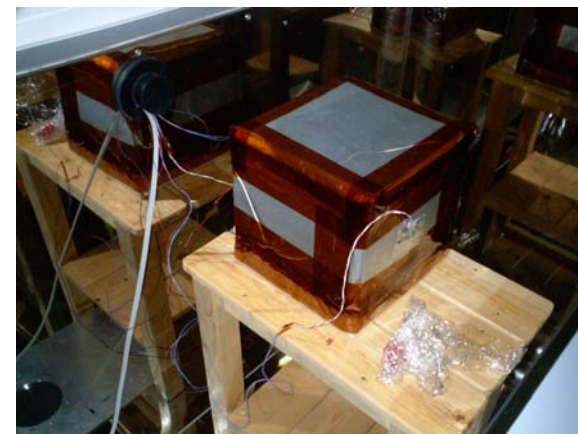
真空断熱材U-Vacua(パナソニック) による保温実験
