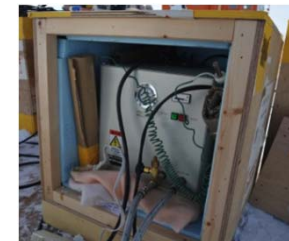
赤外線カメラ 冷凍機用コンプレッサー
