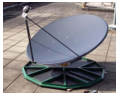
SNODAR 音波の反射を用いた大気擾乱の測定
