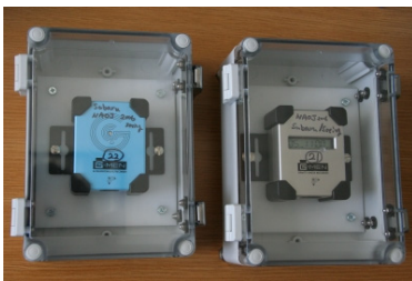
加速度ロガー(左)、梱包に固定した加速度ロガー(右)
