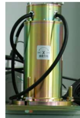
高精度傾斜計による不等沈下の測定
