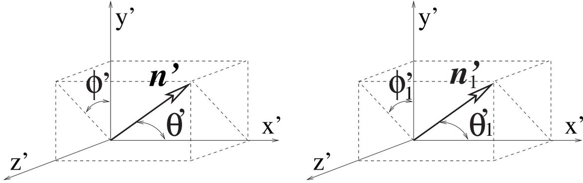
図4  $K'$  系に於ける光子の入射方向、散乱方向単位ベクトル
