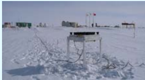
ドームふじに設置したSODAR
