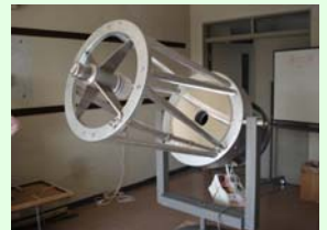
極寒下での駆動を考慮した40cm赤外線望遠鏡(架台は仮)
