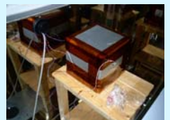
大型超低温槽低温槽内で動作実験中の赤外線カメラコントローラ
