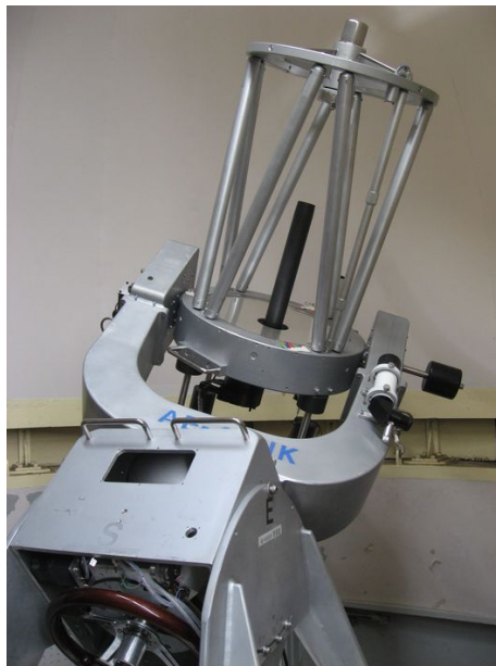
図 4.21 南極 40cm 赤外線望遠鏡に取り付けたバッフル。写真中央の黒い筒状のものがバッフルである。
