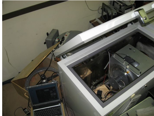
図 5.1 日本フリーザー (株) 社製 CLN-70C 冷凍庫。冷凍庫内には RA 軸ユニットが入れられている。
