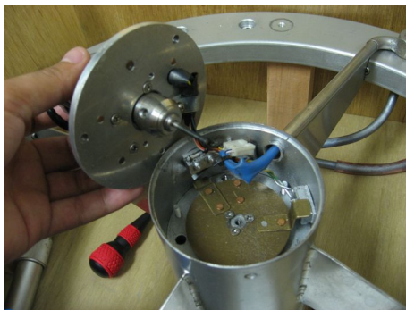
図 5.9 (左) モーターユニットを外した状態。中央のネジで上下動ユニットを上下させる。(右) 上下動ユニット。下から 2 枚目の板がプッシュで、上下動ユニットはグリス潤滑で動く。
