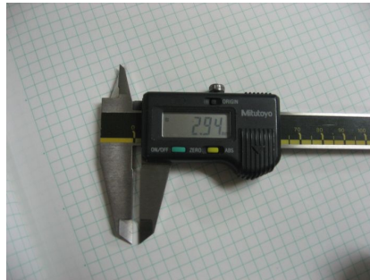
図 5.10 Mitutoyo CD-15CP 電子ノギス。器差 \pm 0.02\text{mm} である。
