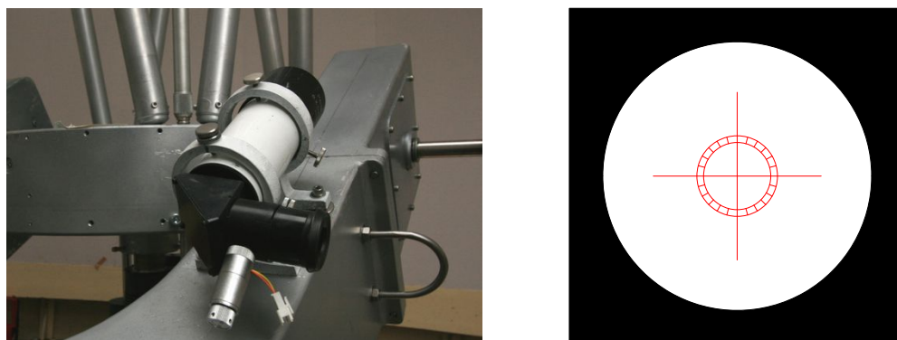
図 B.1 (左) フォーク東側に取り付けられた極軸望遠鏡。6 本の調整ネジによってその向きを調整する。(右) 極軸望遠鏡の十字線パターン。暗視野照明装置によって赤く照らし出される。
