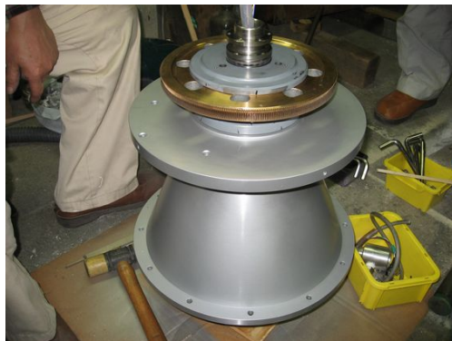
図 4.9 新 RA 軸受け (通称：植木鉢) の組み立て前の写真。上下にベアリングが装着され一体の軸受けとなり望遠鏡の荷重を支える。上部に見えている金色の歯車は RA 軸ウォームホイールである。
