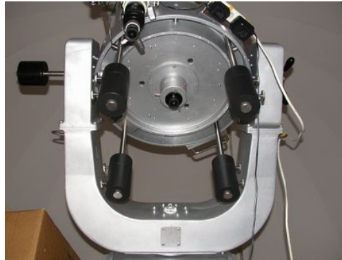
図 4.19 Dec 軸バランスおもり。4本のシャフトを介して望遠鏡に取り付ける。
