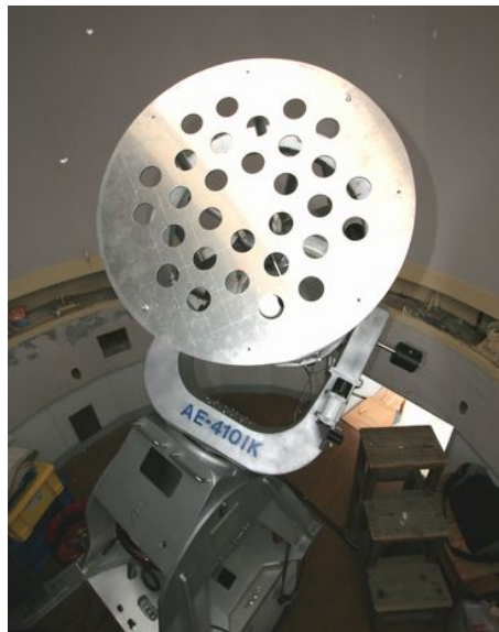
図 8.7 南極 40cm 赤外線望遠鏡のトップリングに取り付けた状態のハルトマン板
