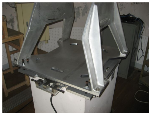
図 B.3 極軸調整プレート。写真手前に見えるネジが水平調整ネジでプレートに垂直に立っているのが高度調整ネジである。
