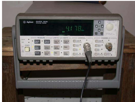
図 4.2 Agilent 53131A ユニバーサルカウンターを用いてパルス数を測定する。
