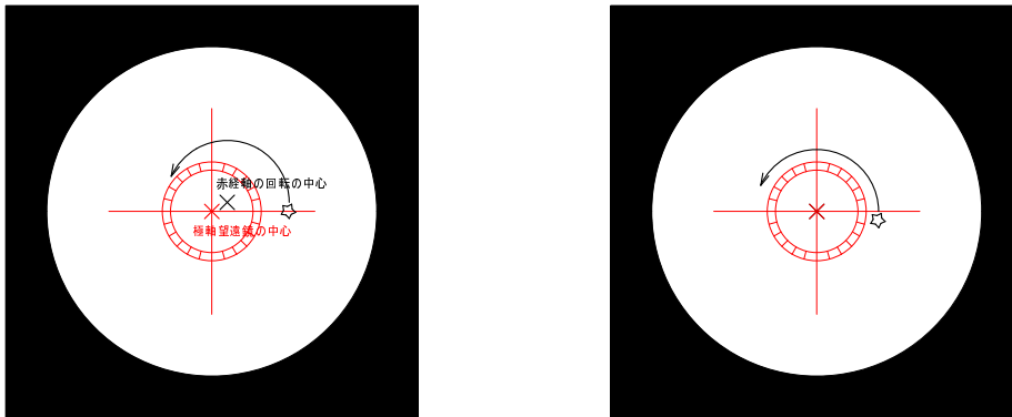
図 B.2 (左) 極軸望遠鏡がずれている状態。星の回転中心位置と十字線の交点が一致していない。(右) 極軸望遠鏡があった状態。
