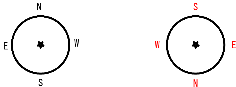
図 B.7 ハンドコントローラーを押して動く方向と実際の方向。(左) コントローラーを押して動く方向、(右) 実際の方向。
