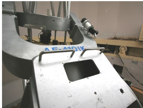
図 4.20 運搬ハンドル。RA 軸ユニットに 4 個、鏡筒にも運搬時 4 個取り付けが可能。
