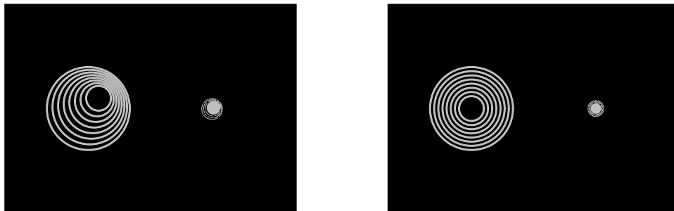
図 C.6 焦点内像 (もしくは焦点外像) では副鏡の影が中心に見えない。また焦点像も「尾」をひいているように見える。(左) 光軸がズレている時の焦点内像と焦点像、(右) 光軸が合っている時の焦点内像と焦点像。
