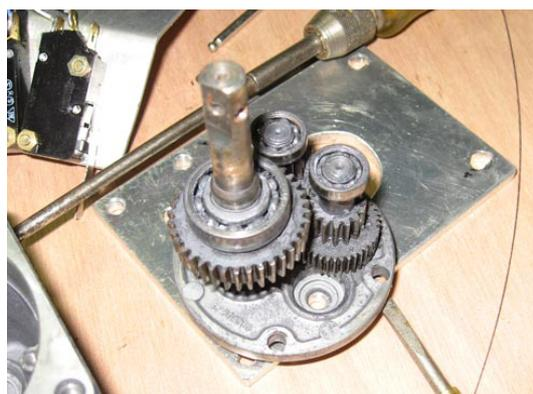
図 1 ギヤ Box 内部。小さなギヤによる伝達で、1/20 に減速する。これら内部回転軸はベアリングによってギヤ Box 筐体に取り付けられている。
