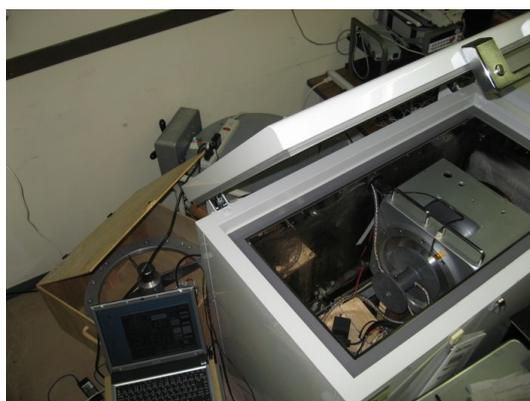
図1 RA 本体ユニット全体を冷凍庫で $-80$  に冷却する
