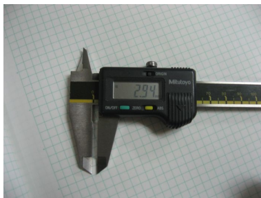
図 6 Mitutoyo CD-15CP 電子ノギス。器差 \pm 0.02\text{mm} である。
