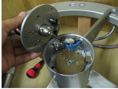
図3 モーターユニットを外した状態。中央のネジで上下動ユニットを上下させる。
