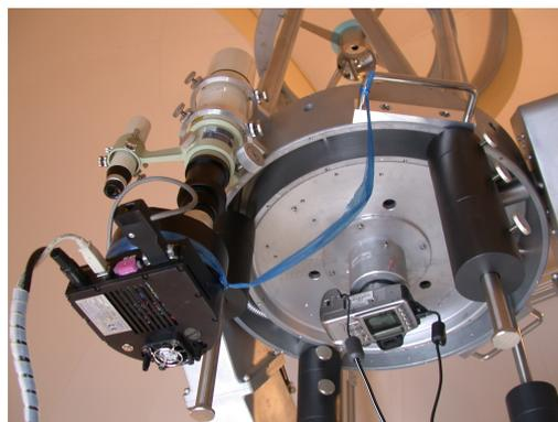
図1 FS-60C に ST-7、AIR-T-40 に Kiss Digital を取り付けた状態
