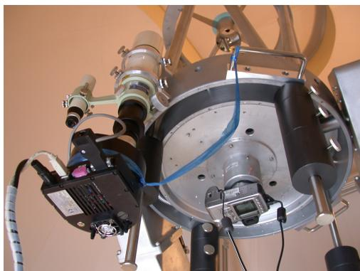
図 2 FS-60C に ST-7、AIR-T-40 に Kiss Digital を取り付け観測を待つ写真
