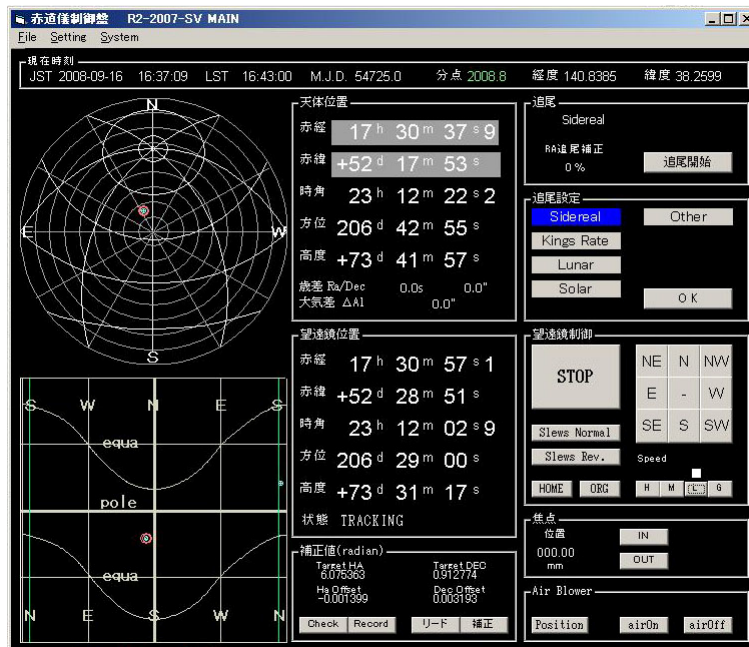
図 2 赤道儀制御盤 R2-2007-SV MAIN
