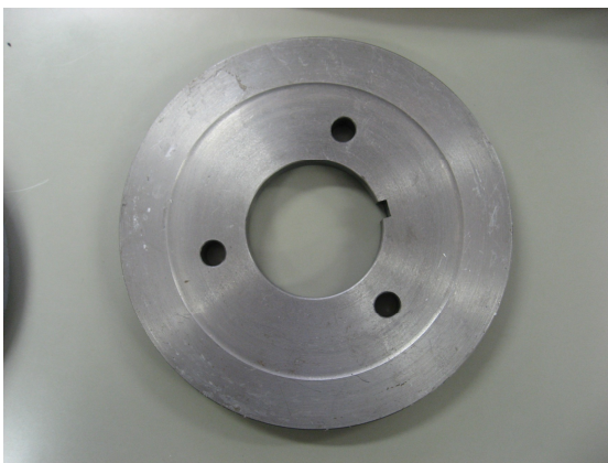
図3. テフロン側のウォーム押さえ。若干テフロンが削れ付着している。
