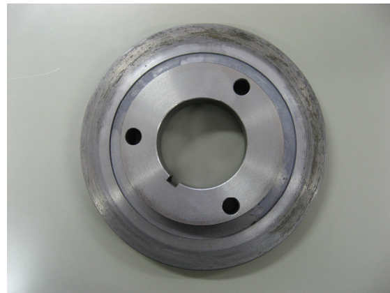
図4. すず板側のウォーム押さえ。すず板が削れ、金属粉が大量に付着。
