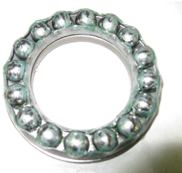
図7. ベアリングに使用されていた緑色のグリス。FOMBLIN グリスは白色で、明らかに異なるグリスが使用されている。
