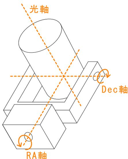
図1 望遠鏡の RA 軸・Dec 軸・光軸
