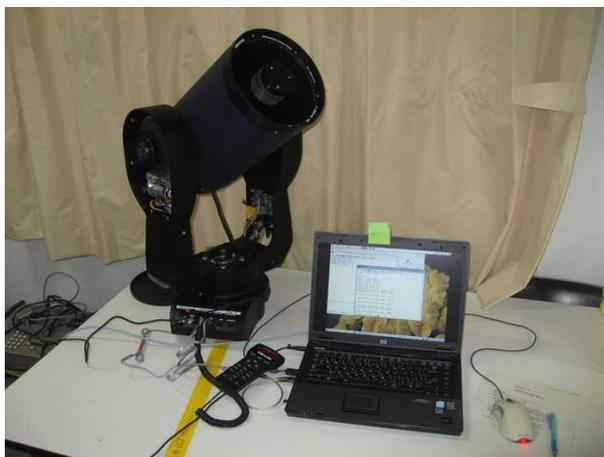
図 1 8" LX200-ACF を Linux PC から制御する実験の様子
