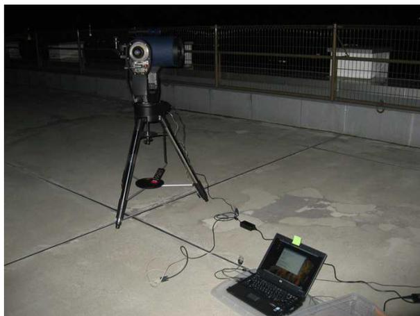
図 3 8” LX200-AFC を Linux PC から制御して天体観測する様子
