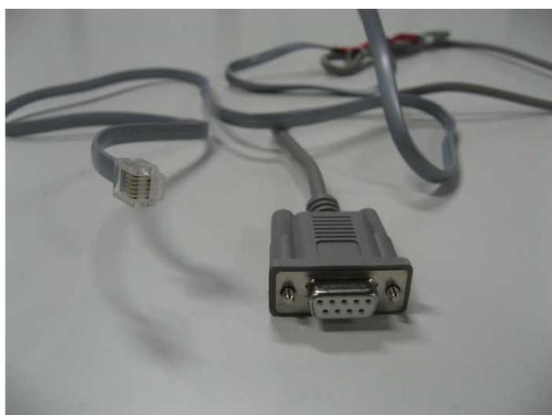
図 2 自作した RS232C-6 ピンモジュラーコネクタ
