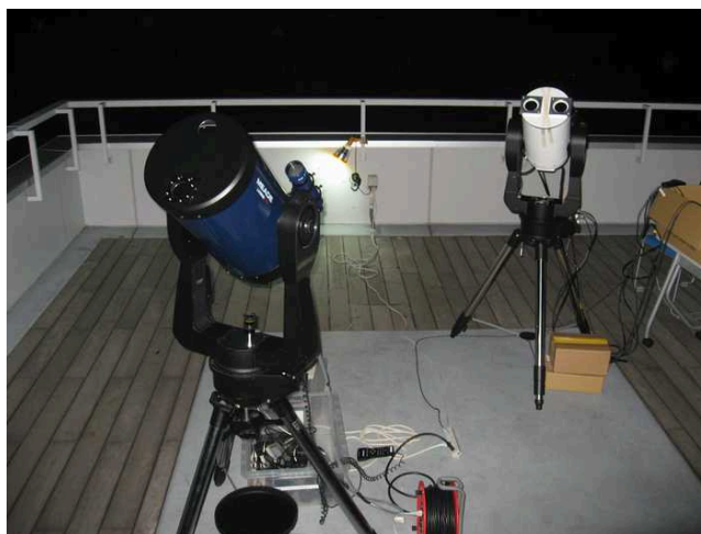
図 3 新東北 DIMM(右) と教育学部 DIMM(左)。東広島天文台 2 階観望用ウッドデッキ北東側のコンクリート基礎上に約 2m 離して設置した。
