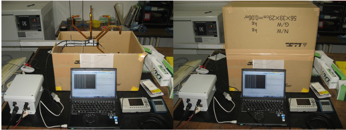
図1 ダンボールで自作した“Zero Air Chamber”
