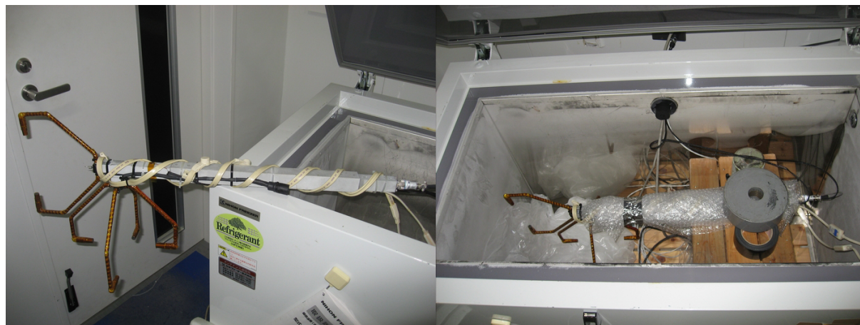
図 2 図左:山清ヒーターを巻いた#SATI-3SX。 図右:山清ヒーターを巻いた後、エアキャップ(緩衝材、プチプチ)で巻いて冷凍庫に入れた#SATI-3SX。
