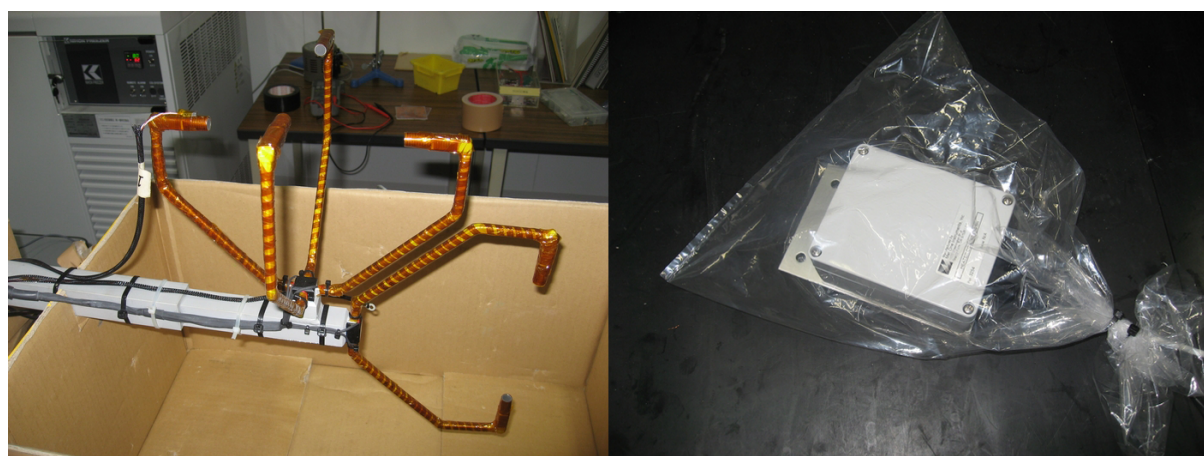
図 1 図左:#SATI-3SX アーム部分。ヒーターが巻き付けられカプトンテープによって固定されている。 図右:アームヒーターを制御する Met One Instruments, Inc Heater Control 50.0H 温度コントローラー。
