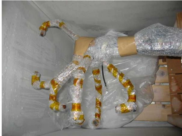
図1 アームヒーター及び山清ヒーターにエアキャップ(緩衝材、プチプチ)で完全に被った#SATI-3SX
