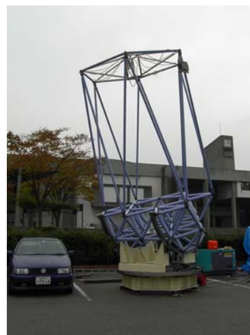
名古屋大学で開発された超軽量望遠鏡架台 (Kurita et al.)
