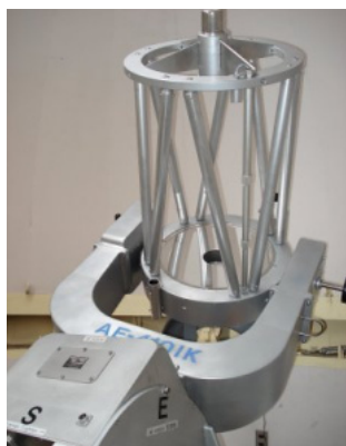
極寒仕様の 40cm 赤外線望遠鏡
