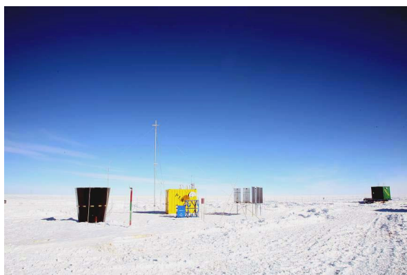
ドーム A に設置された全自動サイト調査観測ユニット PLATO (Storey 氏提供)
