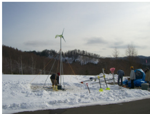
極寒下で風力発電による望遠鏡駆動実験
