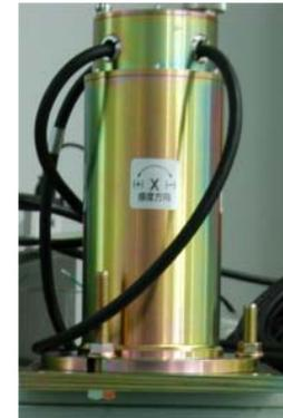
高精度傾斜計による不等沈下の測定(極地研 金)
